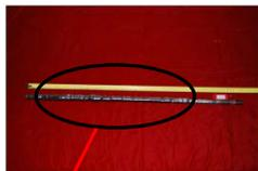
В процессе плавки в месте стыка образуется зона нестабильности, которая приводит к образованию наплывов на поверхности поликристалла и увеличению времени протекания процесса
