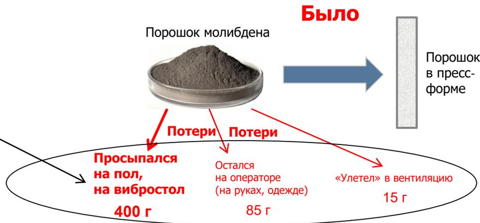
Методом мозгового штурма определён способ модернизации вибростола с целью возврата данных потерь в технологический процесс – установка металлического поддона на вибростол.
