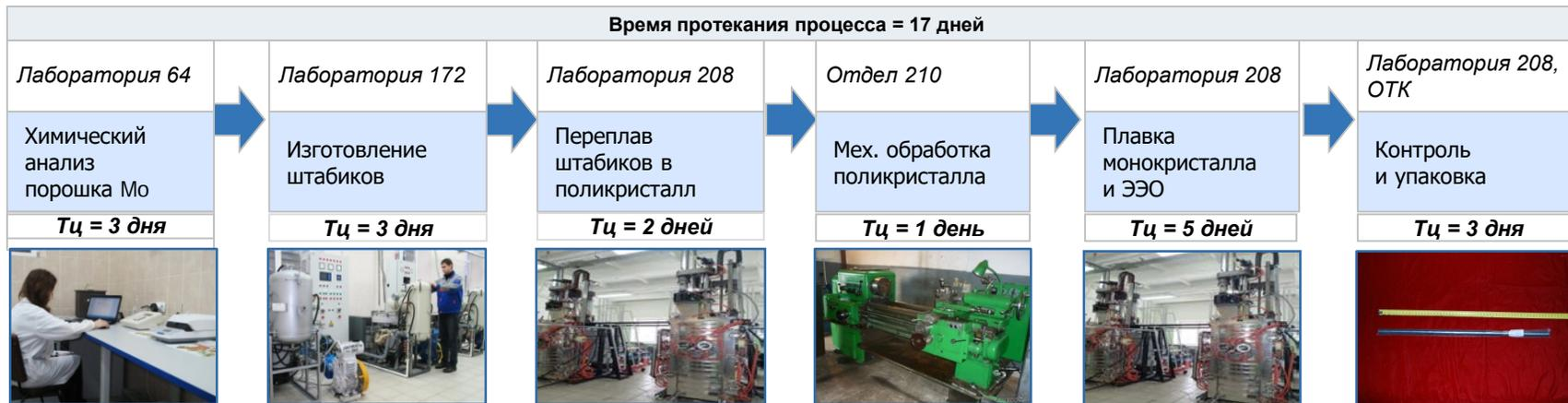
**Сформирован целевой сетевой план-график изготовления прутков Mo-Nb-Zr из расчёта выхода одной партии за 12 дней**
