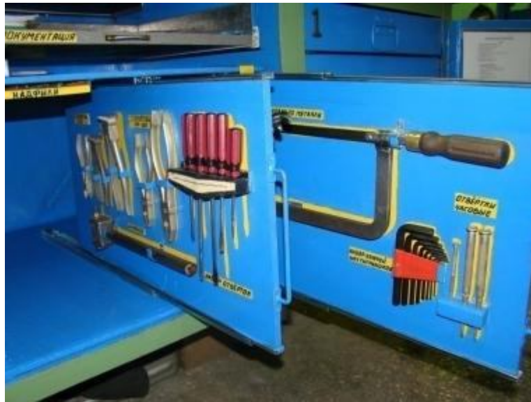
Рис. 11. Метод теней на вертикальных выдвигающих стенках слесарного верстака.
