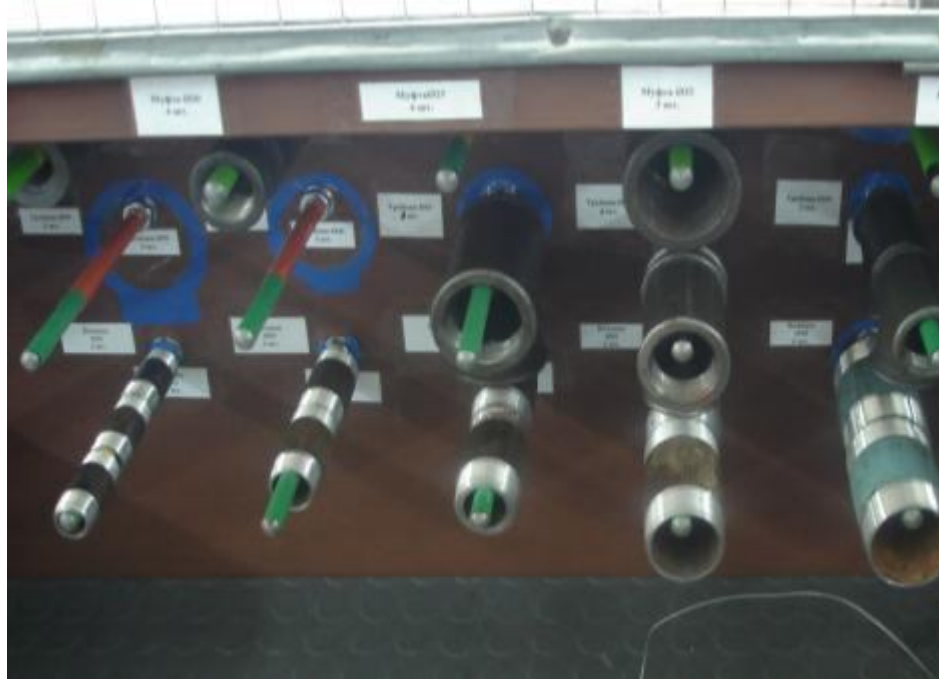
Рис. 10. Пример одновременного использования метода теней и уровня запасов («светофор»)
