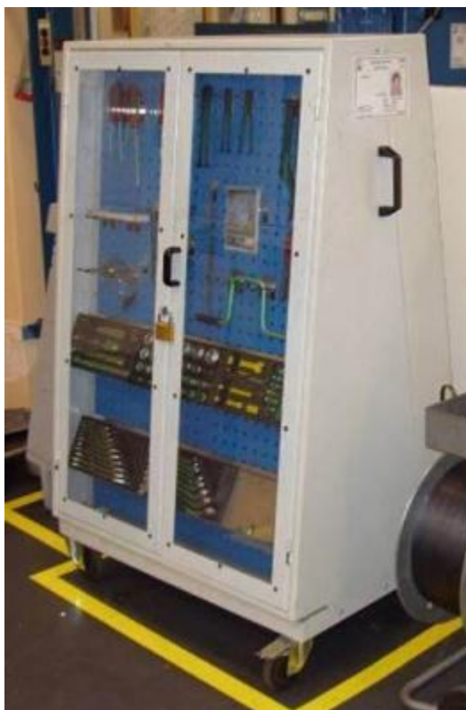
Рис. 13. Передвижной инструментальный шкаф с перфорированной панелью
