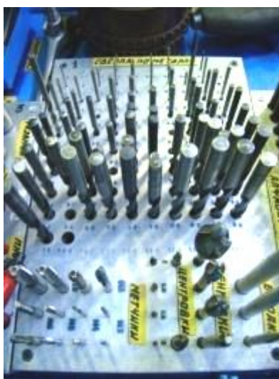
Рис. 31. Вертикальный трафарет для режущего инструмента.
