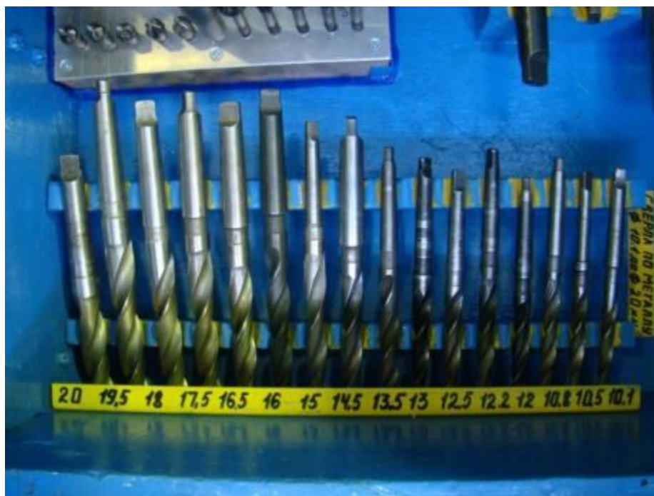
Рис. 32. Горизонтальный ложемент для свёрл.
