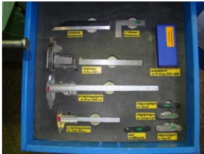
Рис. 23. Применение трафарета в выдвижном ящике
