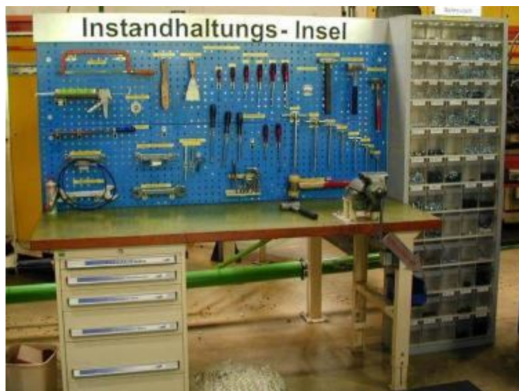
Рис. 12. Оборудование рабочего места специализированной панелью для инструмента.
