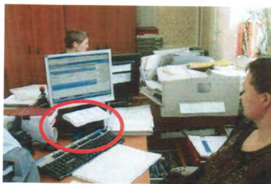
Рисунок 6. Заклейка вентиляционного отверстия из-за выброса порошка
